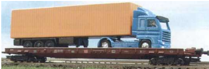
Slika 2. Huckepack tehnologija – Prevoz drumskih vozila željezničkim vagonima
