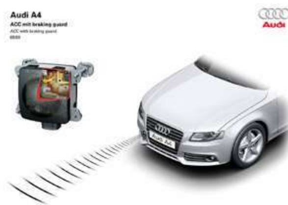
Slika br. 5. Princip funkcionisanja ACC
